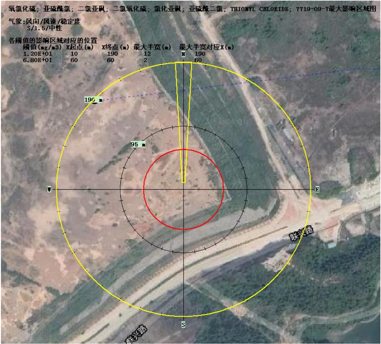
图 1.6-2 常见气象条件下氯化亚砷浓度达到评价标准时的最大影响范围图
